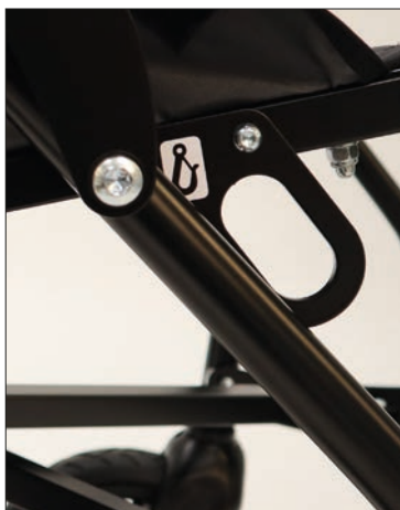
Befestigungspunkte, vorne nach ISO 7176-19
