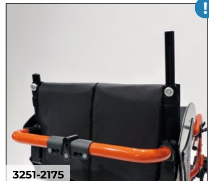
Teleskoprohre in den Rückenrohren
