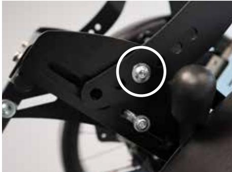
Um die Schrauben zu lösen, zunächst den Stuhl auf 45° kanteln. Anschließend können zuerst die vorderen Schrauben gelöst werden.
