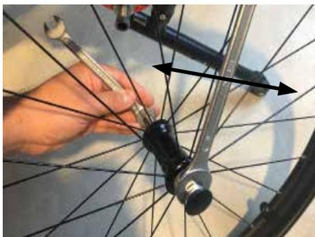
Einstellung der Quick-Release Achse:
