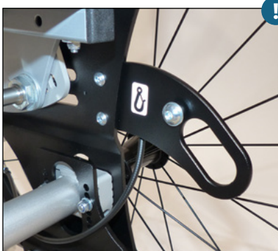
Transportsicherung nach ISO 7176-19
