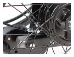
Die Bremskraft kann durch Herausdrehen der Stellschraube verstärkt werden.
