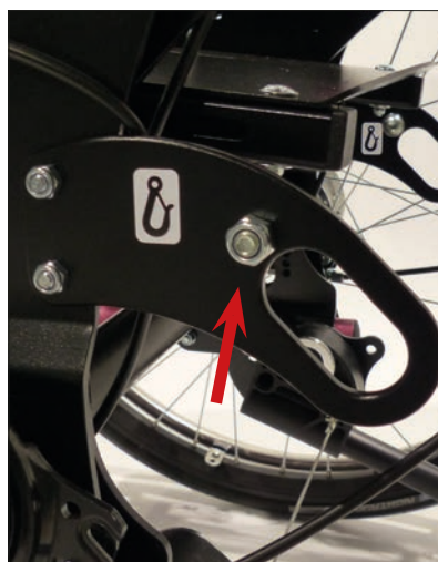
Befestigungspunkt, hinten nach ISO 7176-19 für Beckengurt
