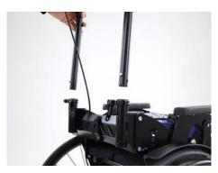
• Stecken Sie danach die Schiebebügel bzw. die Schiebegriffe von oben in die Griffhalter ein.
