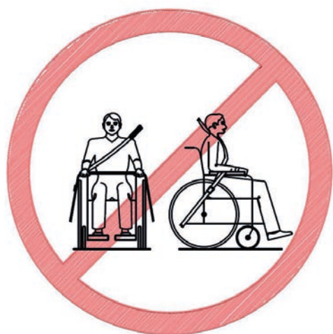
Abbildung einer unzulässigen Gurtführung
