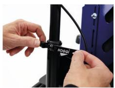
Die Schließkraft des Exzenterhebel kann durch Verstellen der Rändelmutter bei geöffnetem Hebel eingestellt werden (17).
