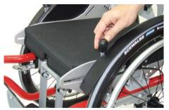
• Ziehen Sie zum Öffnen der Bremse den Bremshebel wie abgebildet nach oben.
