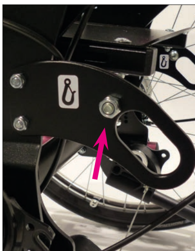
Befestigungspunkt, hinten nach ISO 7176-19 für Beckengurt
