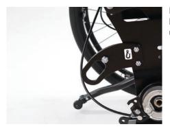
Der Kippschutz wird so eingestellt, dass die Rolle am Ende des Kippschutzrohres über den Radius des Antriebsrades hinausschaut und ca. 2-3 cm über dem Boden steht.
