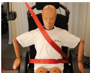
Sicherheitsgurte dürfen nicht durch Rollstuhlkomponenten wie Armlehnen oder Räder vom Körper ferngehalten werden
