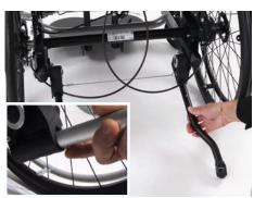
Angeliefert wird Ihr Rollstuhl mit zwei vormontierten Kippschutzaufnahmen. Stecken Sie die Kippschutzrohre in die jeweilige Aufnahme. Drücken Sie die Stativfeder an der Unterseite ein und wählen Sie die gewünschte Längenposition (Detailfoto).
