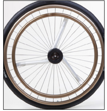
Vorbereitung für die Montage des Einhandantriebes der Firma „Pro Aktiv“
