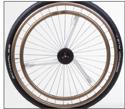
Vorbereitung für die Montage des Einhandantriebes der Firma „Pro Aktiv“
