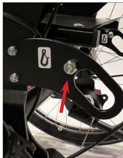
Befestigungspunkt, hinten nach ISO 7176-19 für Beckengurt
