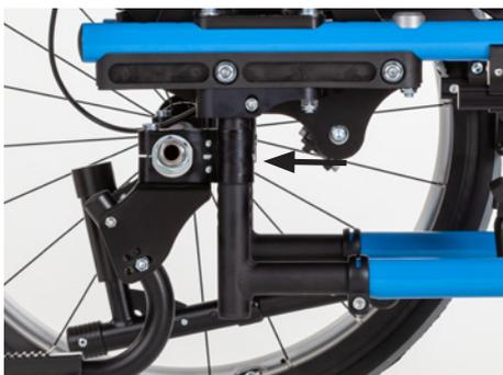
Die Sitzhöhe kann verstellt werden, indem man die Verbindler mit der Achse in verschiedenen Lochpositionen der Achsaufnahme verschraubt
