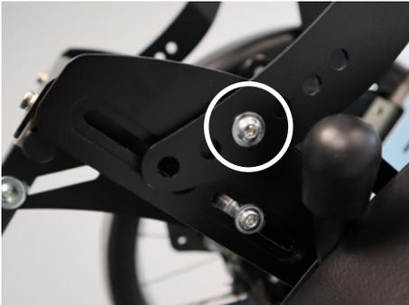
Um die Schrauben zu lösen, zunächst den Stuhl auf 45° kantele. Anschließend können zuerst die vorderen Schrauben gelöst werden.
