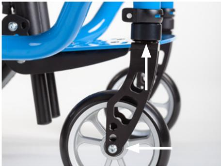
Überprüfung der Verschraubungen:
