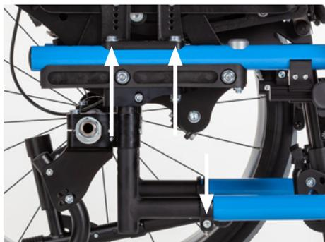
Zum Verstellen des Aktivgrads, müssen die beiden Schrauben zur Fixierung der Radabdeckung entfernt und die Schraube des Sattalklemmrings gelöst werden.
