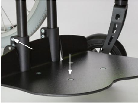
Überprüfung der Verschraubungen:
