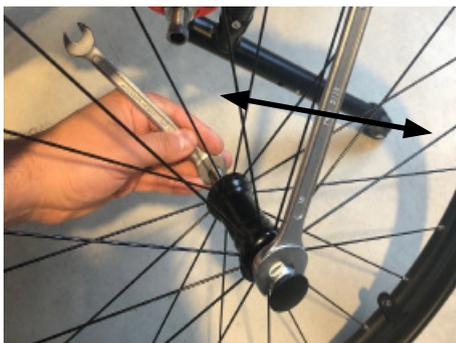
Einstellung der Quick-Release Achse:
