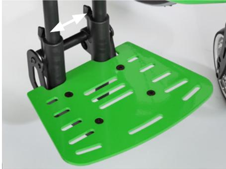
Die Höhenverstellung des Fußbretts erfolgt über das Lösen der rückseitigen Flügelmuttern. Daraufhin, kann das jeweilige auf dem Träger montierte Fußbrett, auf die individuellen Bedürfnisse angepasst werden.
