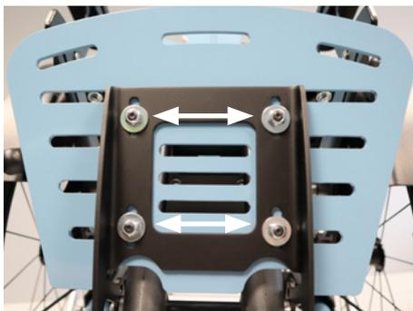
Nach Lösen der vier markierten Verschraubungen am Fußbretthalter kann das Fußbrett in der Tiefe verstellt werden.
