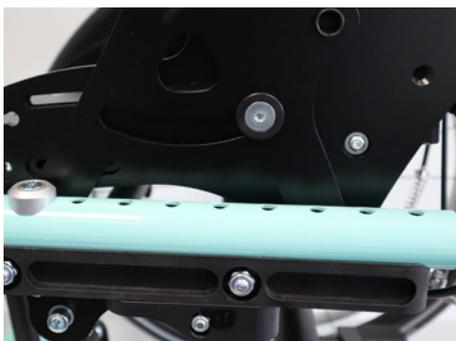
Anschließend können rechts und links die hinteren Schrauben gelöst werden.
