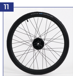
Standard Antriebsrad mit Trommelbremse
