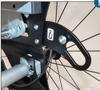
Transportsicherung nach ISO 7176-19
