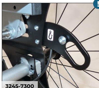
Transportsicherung nach ISO 7176-19
