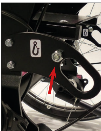
Befestigungspunkt, hinten nach ISO 7176-19 für Beckengurt
