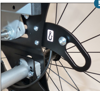
Transportsicherung nach ISO 7176-19
