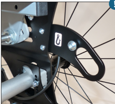
Transportsicherung nach ISO 7176-19
