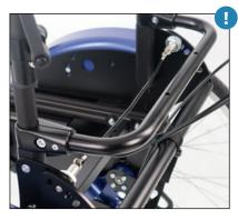
Auslösung der Rückenwinkelverstellung
