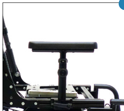
Säulenarmlehnen mit PU-Auflagen, abnehmbar, höhenverstellbar
