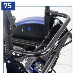
75 Auslösung der Rückenwinkelverstellung
