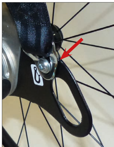
Befestigungspunkt, hinten nach ISO 7176-19 für Beckengurt
