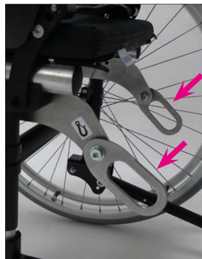
Befestigungspunkte, hinten nach ISO 7176-19
