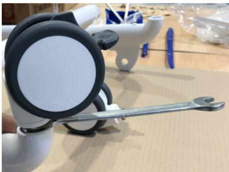
Lösen sie hierzu die Verschraubung mit einem 13 mm Schraubenschlüssel und drehen Sie das Rad ab. Das neue Rad wird in umgekehrter Reihenfolge wieder fest angezogen. Sichern Sie die Schraubverbindung mit entsprechender Unterleg- und Federscheibe.
