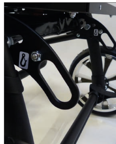
Befestigungspunkte, hinten nach ISO 7176-19
