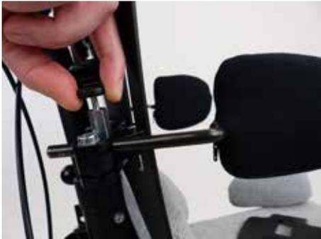
Falls die abklappbare Version installiert ist, kann die Pelotte zusätzlich durch Betätigen des abgebildeten Zugschnäppers in 3 Winkeln eingestellt und zusätzlich auch abgeklappt werden.
