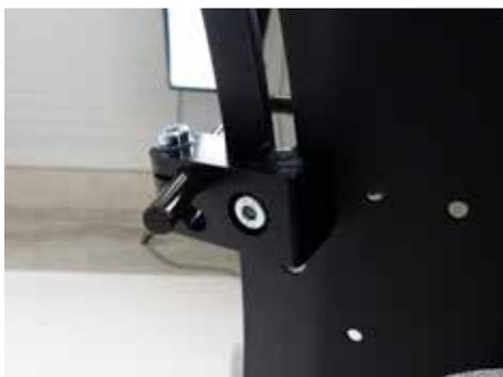
Durch Öffnen der abgebildeten Schraubverbindung kann der Pelottenarm in der Tiefe, Breite und Höhe eingestellt werden.
