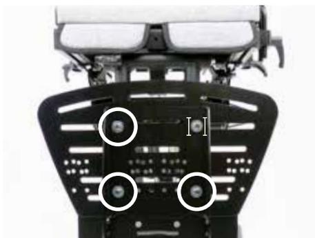
Nach Lösen der markierten Verschraubungen am Fußbretthalter kann das Fußbrett in der Tiefe (durch das Versetzen der Verschraubungen in den Langlöchern) verstellt werden.
