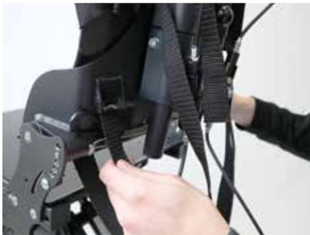
Die unteren Gurte unter der Rückenbasis von vorne nach hinten durch führen und oberhalb des Rastbolzenzuges der Rückenwinkelverstellung in die geöffneten Klappschnallen einführen.
