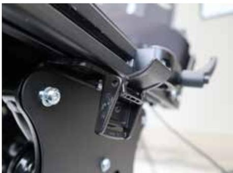
Für die vorderen Gurtenden müssen zunächst Klappschnallen auf der Unterseite des Systemprofils befestigt werden.
