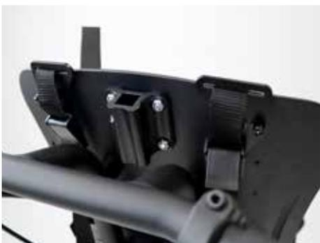
Schultergurte der Fixationsweste durch die Gurtführungen am oberen Rückenblech nach hinten führen.
