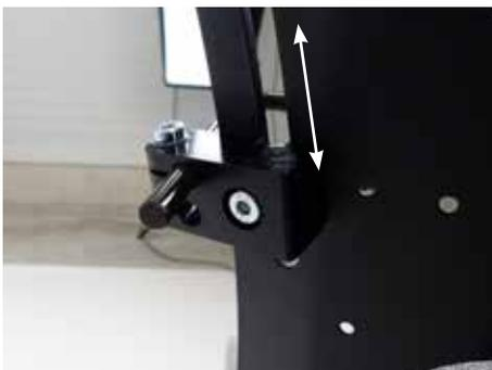
Die generelle Höhenverstellung erfolgt über das Lösen der abgebildeten Schraubverbindung und das Verschieben der gesamten Einheit innerhalb des Langloches des Rückenblechs.
