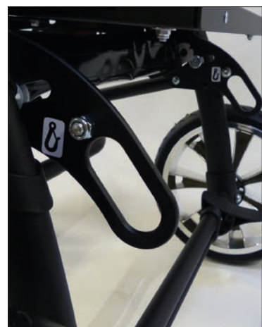
Befestigungspunkte, hinten nach ISO 7176-19
