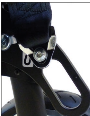
Befestigungspunkt, hinten nach ISO 7176-19 für Beckengurt
