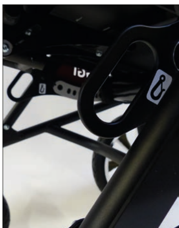
Befestigungspunkte, vorne nach ISO 7176-19
