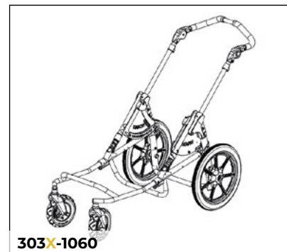
Cross mit Geräteträger-Vorsatz, für Zusatzgeräte
