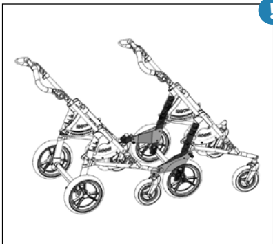
Verbindungsstücke zur Kopplung zweier BINGO Evolution Straßengestelle hintereinander inkl. Lenkstopp am hinteren Straßengestell
