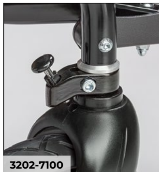
Lenkstopp für Kunststofflenkgabeln
