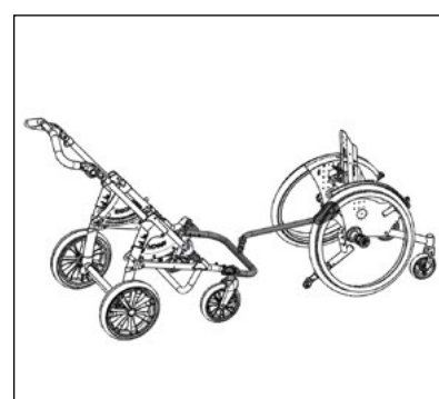
Verbindungssteile zur Kopplung eines BINGO Evolution Straßengestells und eines HOGGI Rollstuhls
