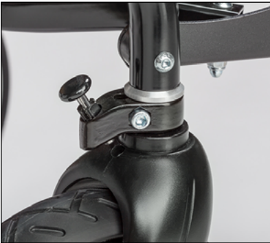
Lenkstopp für Kunststofflenkgabeln
