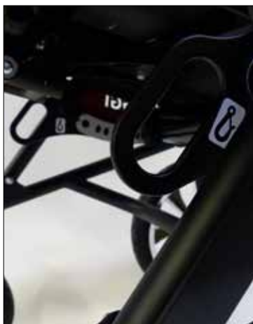
Befestigungspunkte, vorne nach ISO 7176-19
