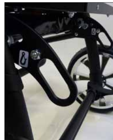
Befestigungspunkte, hinten nach ISO 7176-19
