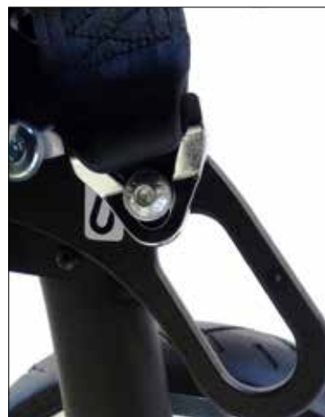
Befestigungspunkt, hinten nach ISO 7176-19 für Beckengurt
