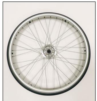
24" Raddurchmesser mit Trommelbremse & Alu-Greifreifen
