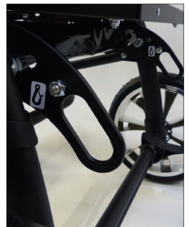
Befestigungspunkte, hinten nach ISO 7176-19
