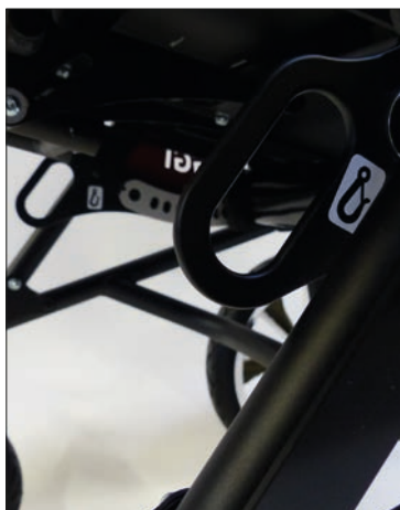
Befestigungspunkte, vorne nach ISO 7176-19
