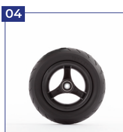
PU-Bereifung Vorderrad, auf 6-Speichenfelgen
