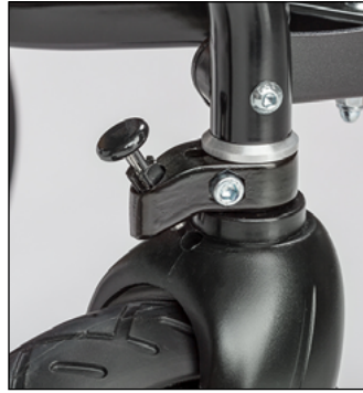
Lenkstopp für Kunststofflenkgabeln
