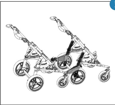
Verbindungssteile zur Kopplung zweier BINGO Evolution Straßengestelle hintereinander inkl. Lenkstopp am hinteren Straßengestell
