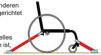
4) Der Reha-Faltbuggy muss mit einem Rückhaltesystem gemäß ISO 10542 oder SAE J2249 mit nicht verstellbaren Gurten vorne und verstellbaren Gurten hinten gesichert werden, dabei handelt es sich zum Beispiel um Karabinerhaken/S-förmige Haken sowie um Steckverschlüsse. Die Rückhaltesysteme bestehen normalerweise aus 4 Einzelgurten, die an den vier Ecken des Produktes befestigt werden. Die Befestigungspunkte der Rollstuhlrückhaltesysteme sind mit dem internationalen Haken-Symbol gekennzeichnet.
