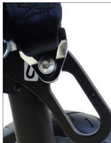
Befestigungspunkt, hinten nach ISO 7176-19 für Beckengurt
