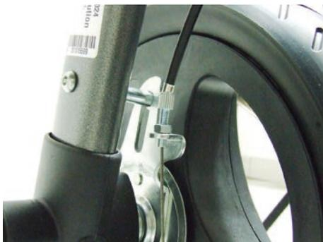
Nach Lösen der Kontermutter an der Bowdenzugführung kann durch hinein oder heraus drehen der Bowdenzugführung die Vorspannung der Bremse eingestellt werden.
