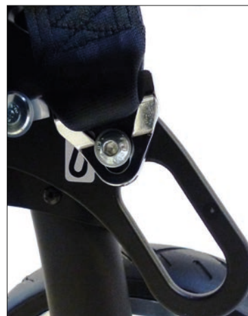
Befestigungspunkt, hinten nach ISO 7176-19 für Beckengurt
