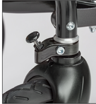
Lenkstopp für Kunststofflenkgabeln
