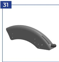
Radabdeckung mit integrierter Bremse
