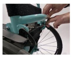
Ziehen Sie wie abgebildet mit einer Hand das Auslöseseil und bewegen Sie mit der anderen Hand die Rückenkonstruktion nach hinten.
