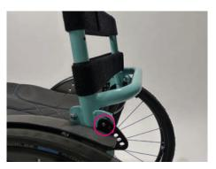
• Lassen Sie beide Bolzen in der gewünschten Rückenwinkelposition akkustisch hörbar einrasten.
