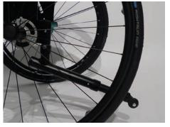
Der Kippschutz wird so eingestellt, dass die Rolle am Ende des Kippschutzrohres über den Radius des Antriebsrades hinausschaut und ca. 2-3 cm über dem Boden steht.
