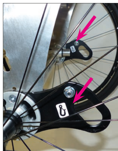
Befestigungspunkte, hinten nach ISO 7176-19
