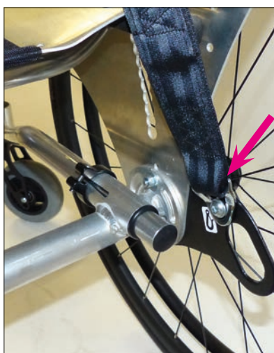
Befestigungspunkt, hinten nach ISO 7176-19 für Beckengurt
