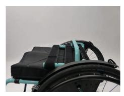
Wenn Ihr **CESA** mit dem **winkelverstellbarem Rücken** ausgestattet ist, kann es sein, dass er für den Transport abgeklappt ist.
