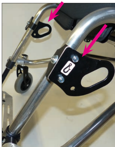
Befestigungspunkte, vorne nach ISO 7176-19
