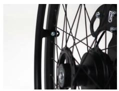
Alle Greifreifen können in der Position "eng" oder der Position "weit" angebaut werden. Auch hier ist ein späterer Umbau durch den Fachhändle
