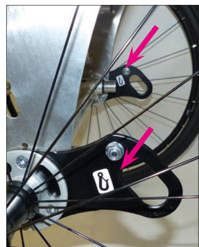
Befestigungspunkte, hinten nach ISO 7176-19
