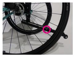
Nach Drücken der Stativfeder kann die Länge des Kippschutzrohres in der Kippschutzaufnahme in drei Positionen (mit jeweils 2,5 cm Abstand) eingestellt werden.
