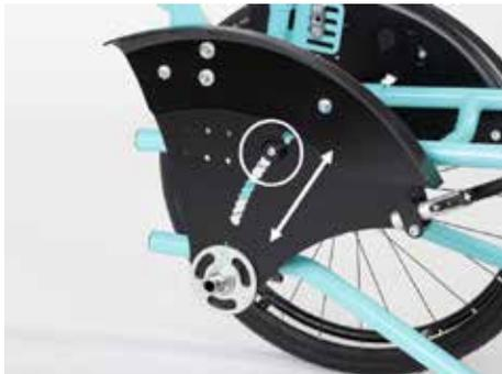
Dann, über das Lösen der Verschraubung zur Basisplatte den Sitzrahmen innerhalb des Langloches nach oben und unten verschieben und somit den/die Sitzwinkel/ hintere Sitzhöhe zu verstellen, bzw. anzupassen.
