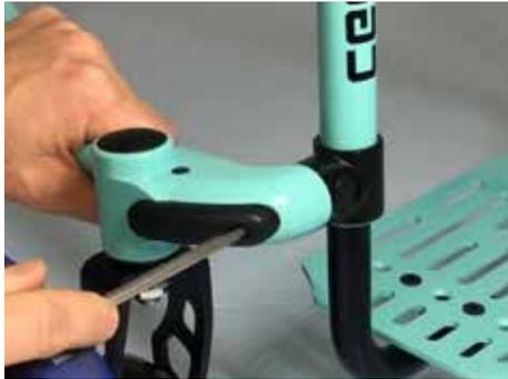
Überprüfung der Schraubverbindung zwischen Unterzügen und Sitzrahmen.
