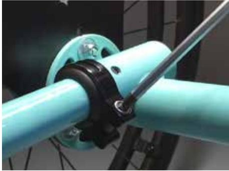
Lösen der Verschraubung rechts und links an den Klemmschellen des Achsrohrs
