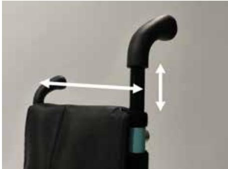
Anschließend kann die Höhe neu eingestellt und um weitere Klettstreifen ergänzt werden.
