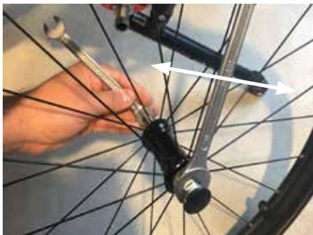
Einstellung der Quick-Release Achse:
