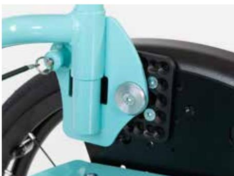
Die Rückenbasis „winkelverstellbar“ wird über einen Rastbolzenzug auf der Rückseite bedient.  $6^\circ$  jede Lochposition
