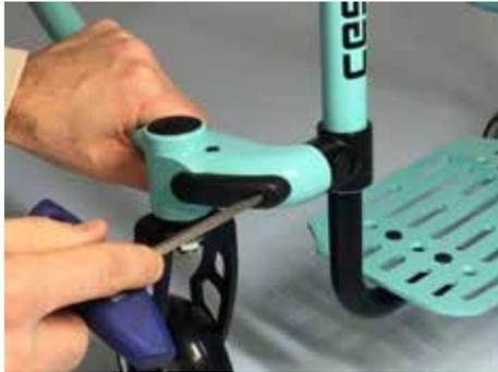
Dann die Schraube am vorderen Rahmen lösen
