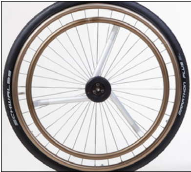
Vorbereitung für die Montage des Einhandantriebes der Firma „Pro Aktiv“
