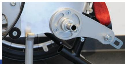
Zwei vordere **Kraftknotensysteme** mit jeweils einer genormten Schloßzunge bzw. Schwerlastöse für Spannretraktor oder Statigurt.
