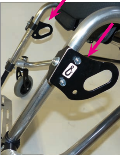
Befestigungspunkte, vorne nach ISO 7176-19
