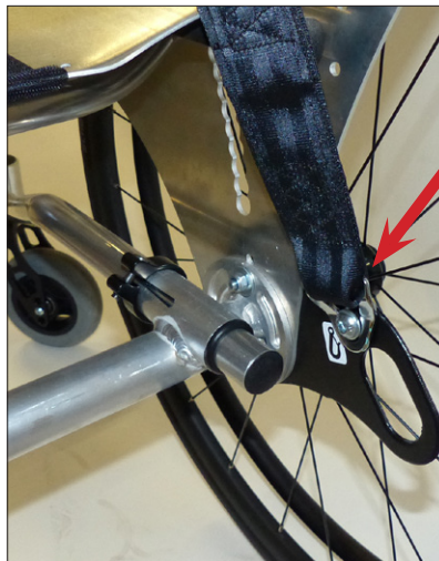
Befestigungspunkt, hinten nach ISO 7176-19 für Beckengurt
