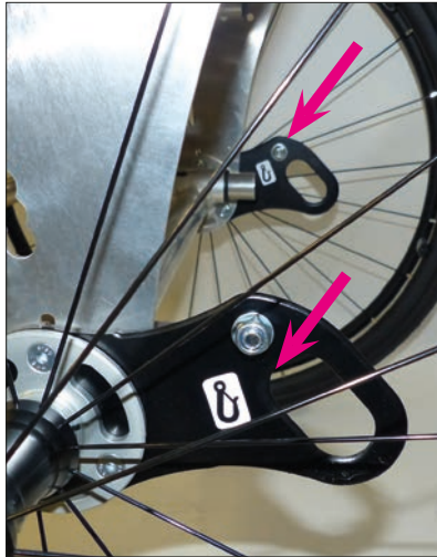
Befestigungspunkte, hinten nach ISO 7176-19
