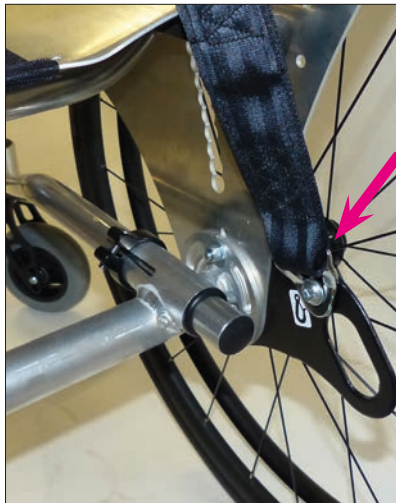
Befestigungspunkt, hinten nach ISO 7176-19 für Beckengurt
