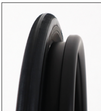
Geschlossener ergonomischer Greifreifen
