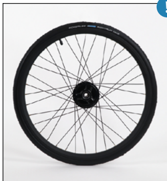
Antriebsrad HOGGI light mit Trommelbremsen
