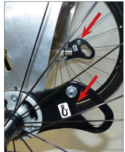
Befestigungspunkte, hinten nach ISO 7176-19
