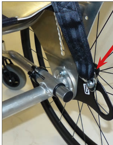
Befestigungspunkt, hinten nach ISO 7176-19 für Beckengurt
