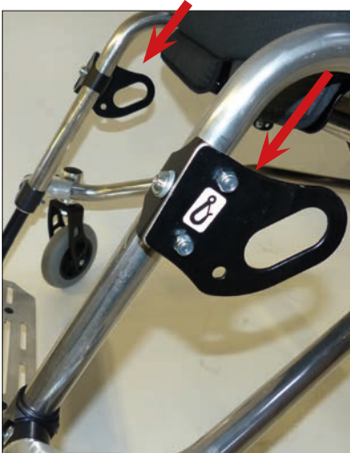
Befestigungspunkte, vorne nach ISO 7176-19
