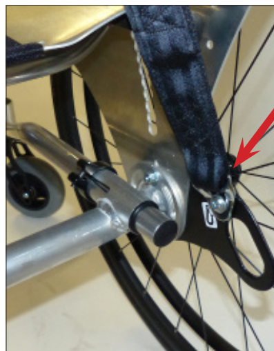
Befestigungspunkt, hinten nach ISO 7176-19 für Beckengurt
