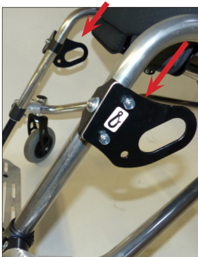
Befestigungspunkte, vorne nach ISO 7176-19
