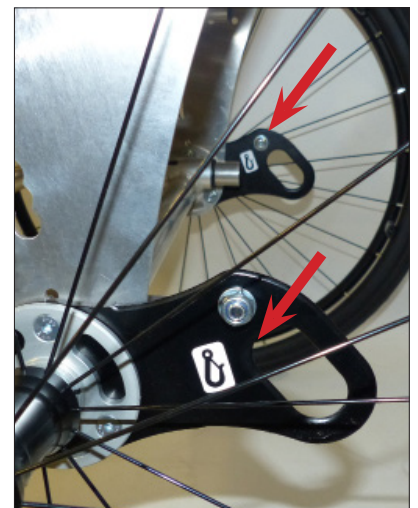
Befestigungspunkte, hinten nach ISO 7176-19
