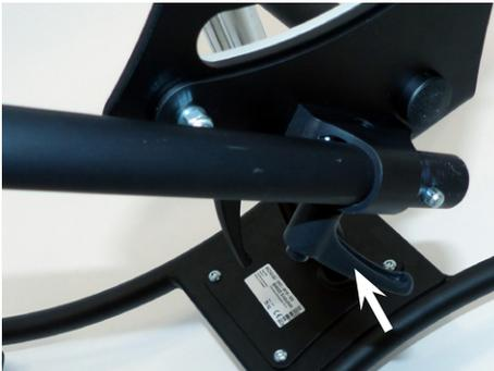
Nach Lösen des Stellhebels an der Klemmeinheit kann der Schiebegriff im Winkel verstellt werden. Ein Wegdrehen des Schiebegriffes ist vor dem Abnehmen von Sitzsystemen mit langen Rückenlehnen notwendig.
