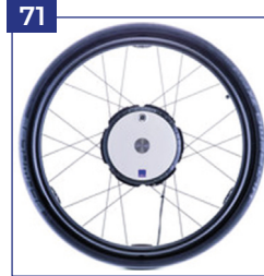
Electric drive „e-fix“
