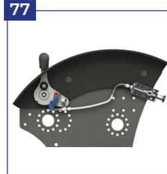
77 Verriegelung der Integrierten Bremse
