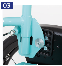
Rückenbasis, winkelverstellbar u. abklappbar
