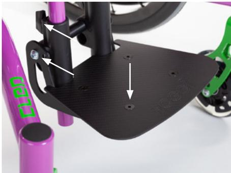
Überprüfung der Verschraubungen:
