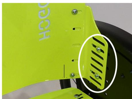
Um das Rückenblech gegenüber der Basisplatten zu verschieben, müssen die gekennzeichneten Schrauben links und rechts gelöst werden.
