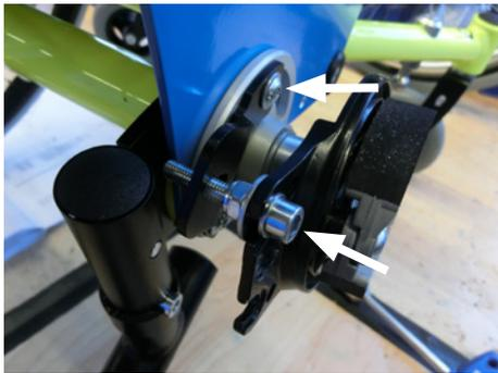
Überprüfung der Verschraubungen:
